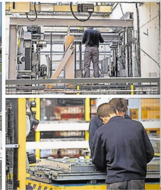
L'usine Otis de Gien s'étend sur 42 000 m 2 . Un technicien prépare un test d'ascenseur. Deux ouvriers posent des rivets sur une plateforme d'ascenseur.
